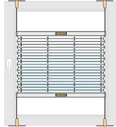
Diese Klemmträger sind nur für Fenster mit Gummidichtung geeignet. Beachten Sie beim Aufmaß die Tiefe des Fensterflügels.
