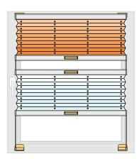
Die auf dem Fensterrahmen geschraubte Montagetechnik mit Winkelträgern kann an allen Fensterarten vorgenommen werden. Erhältlich sind die metallenen Winkel in unterschiedlichen Farben passend zur Auswahl der Profilfarbe. Beim Aufmaß ist darauf zu achten, dass die Plisseeanlage nicht mit Fensterbeschlägen wie dem Fenstergriff kollidiert. Ein seitlicher Überstand von je 1,5 cm pro Seite ist zu empfehlen.
